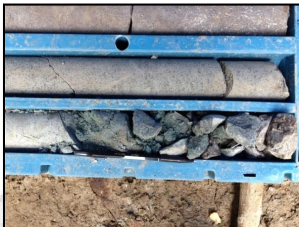
Gambar 2. Inti Core Indikasi Jepitan pada Kedalaman 116,7-131,45 meter
