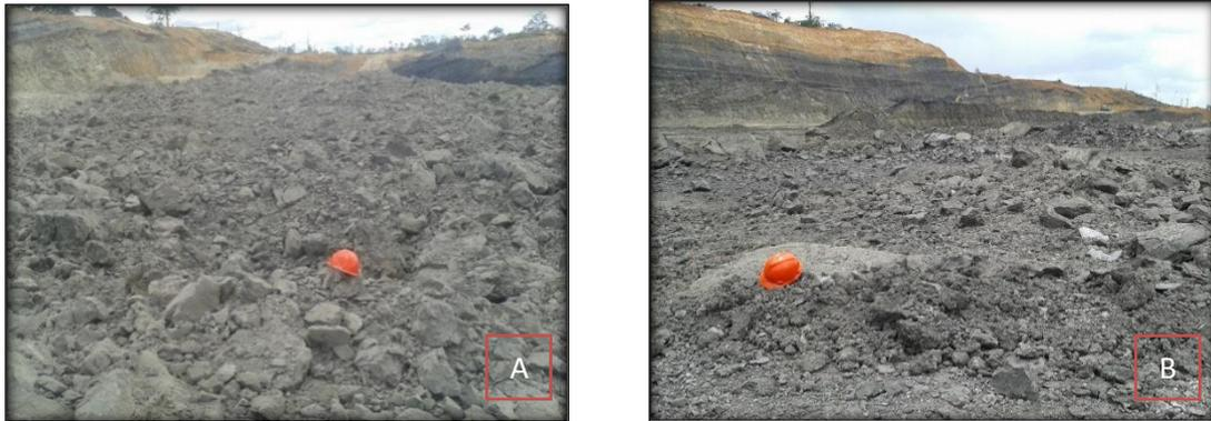
**Gambar 2 .**Kondisi Material Hasil Peledakan Konvensional (A), Kondisi Material Hasil Peledakan Trial Dengan Penambahan Air Decking (B)
