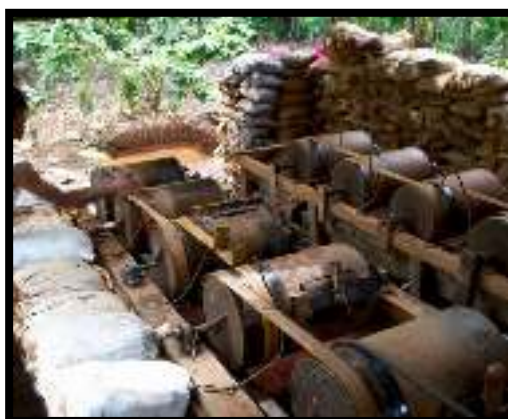
Gambar 1. Pengolahan Bijih Emas Dengan Amalgamasi
