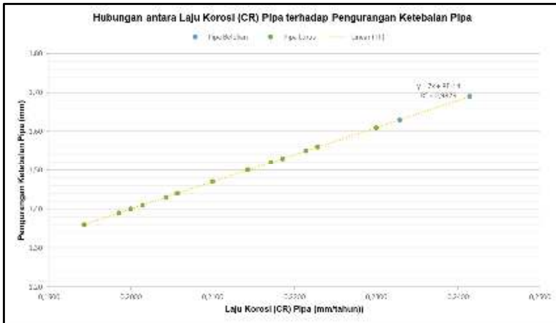
Gambar 3. Grafik Hubungan antara Laju Korosi (CR) terhadap Pengurangan Ketebalan Pipa
