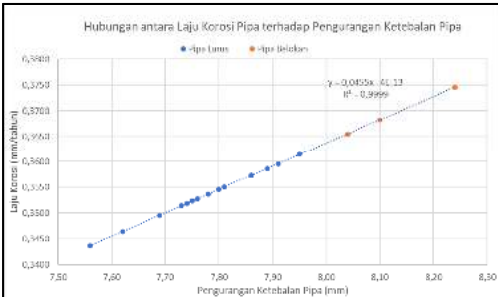
Gambar 3. Grafik Hubungan antara Laju Korosi Pipa terhadap Pengurangan Ketebalan Pipa
