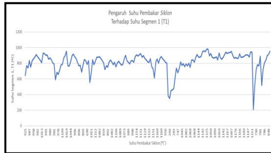
Gambar 3 Pengaruh Suhu Pembakar Siklon Terhadap Suhu Segmen 1 (T1) Setelah Jam Ke - 20
