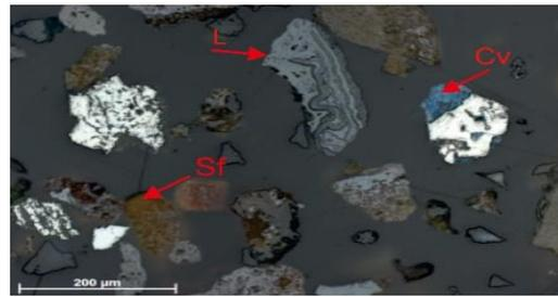
**Gambar 4.** Hasil Pengujian Analisis Mineragrafi
