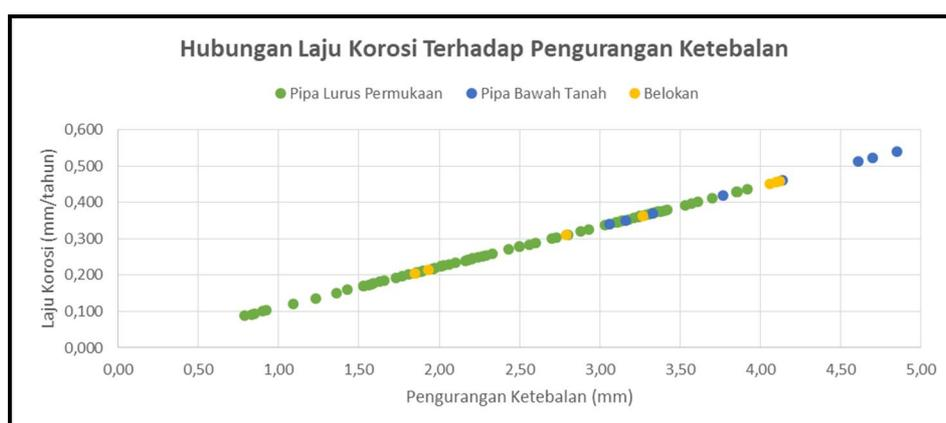
**Gambar 2.** Hubungan Laju Korosi Terhadap Pengurangan Ketebalan
