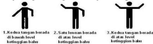
**Gambar 2.** Klasifikasi sikap kerja bagian lengan
