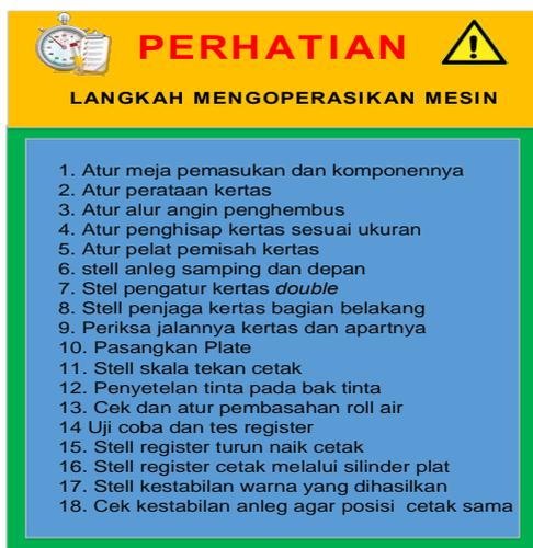
Gambar 10 Tahapan Pengoperasian Mesin
