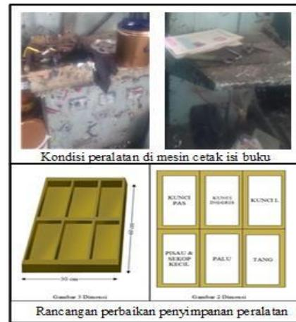
**Gambar 7.** Rancangan Penyimpanan Alat untuk Stasiun Mesin Cetak Isi Buku
