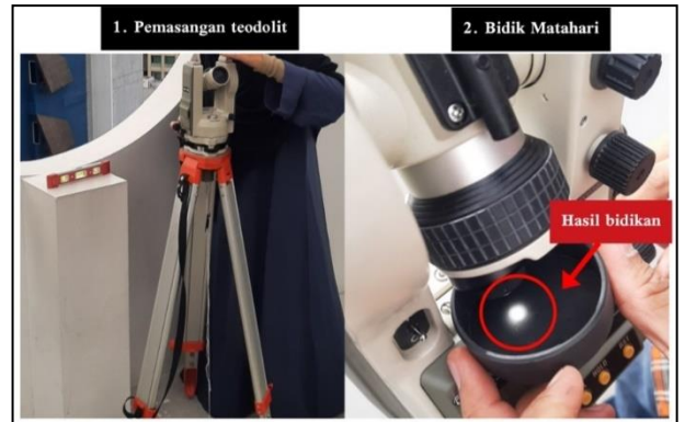
Gambar 1. Pemasangan Alat dan Bidikan Matahari
