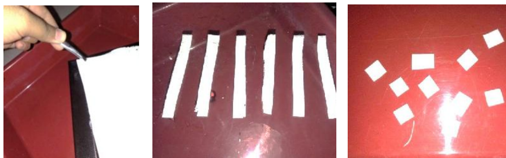
Gambar 1. Hasil pembuatan lembaran strip indikator (PMMA:PSf:Purpald komposisi 2:6:1)
