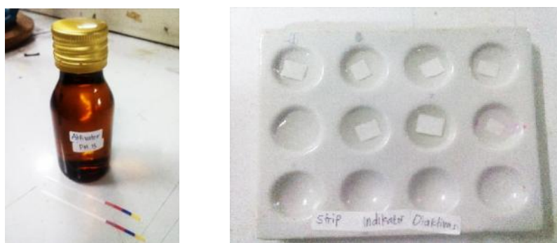
Gambar 2. Hasil aktivasi dengan aktivator NaOH 0,1 M pH 13
