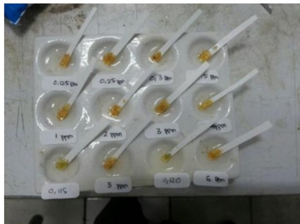
**Gambar 7.** Uji Batas Deteksi
