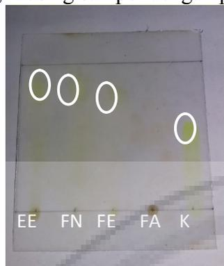
**Gambar 4.** Kromatogram pemantauan ekstrak dan fraksi dengan penampak bercak  $\text{AlCl}_3$  1%
