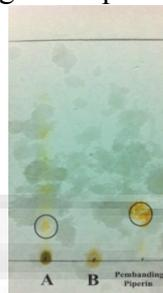
**Gambar 3** Kromatogram pemantauan KLT, [pemantauan secara visual, fraksi alkaloid netral atau basa lemah (A) dan fraksi alkaloid basa (B), pembandingan piperin, FD: silika gel GF<sub>254</sub>, FG: n-heksan:etil asetat (4:6)]
