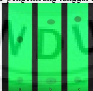
**Gambar 7** Kromatogram pemantauan KLT pengembang tunggal (satu dimensi) dibawah lampu UV 254 nm [FD: silika gel GF<sub>254</sub>, FG: campuran pelarut (a) n-heksan:etil asetat (8:2), (b) etil asetat 100%, (c) metanol 100%]
