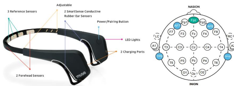
Gambar 1. Muse Headband dan Letak Sensor
