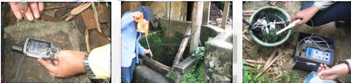
**Gambar 1.** a. Pengukuran Kedudukan sumur, mata air dan air permukaan. b. Pengukuran kedalaman MAT. c. Pengukuran Parameter Fisika dan Kimia Air Insitu
