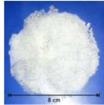
Gambar 3. Membran serat PEC (setelah dikeringkan dalam desikator) (Darma, 2015:43)
